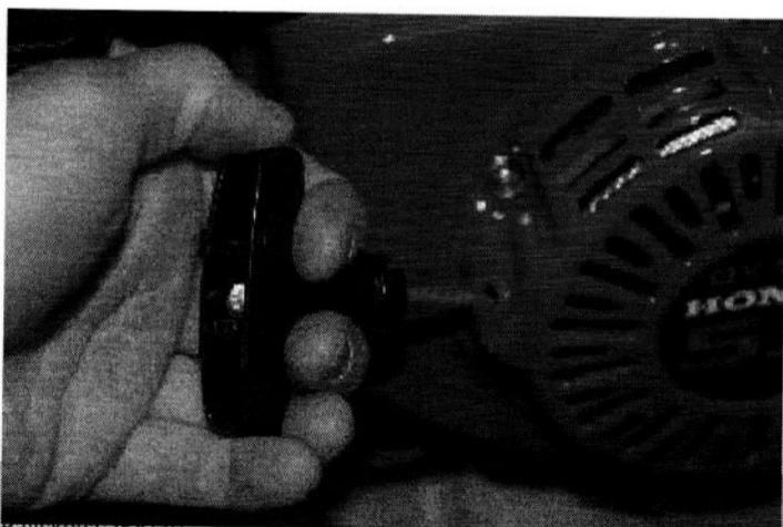
zachytila za upevňovací koš umístěný na setrvačnicku motoru). Energicky zatáhnout. V případě, že se motor nepustí, je třeba pokusy opakovat, dokud se nám to nepodaří. Jestliže se lankem startéru trhne přes ozubení spojky, způsobí to prudké udeření součástí spojky do upevňovacího koše, což může způsobit přetrhnutí lanka startéru. Trhnutí lankem až do konce
